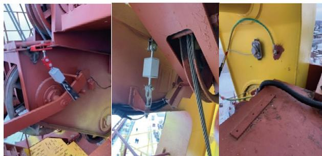
Рис. 3. Пример привязки датчиков усилия и вылета к металлоконструкции крана
