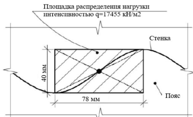
Рис. 3 Схема приложения нагрузки на балку
